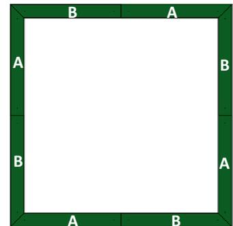
Legen Sie alle Sitzauflagen entsprechen der Skizze auf die Seitenteile auf. Verschrauben Sie die Sitzauflagen mit den Seitenteilen von oben mit je 4 Schrauben (6x80 mm) pro Sitzauflage.
