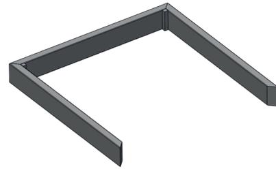
An jeder Ecke werden mit je 3 Schrauben (6x100 mm) die Seitenteile fixiert. Achten Sie darauf, dass die Seitenteile im rechten Winkel passgenau zueinander stehen.
