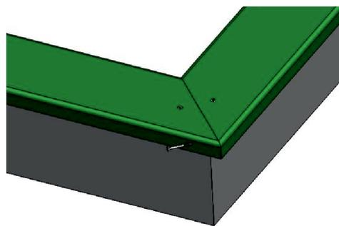
An jeder Ecke wird zusätzlich noch eine Schraube (6x80 mm) eingedreht. Achten Sie bei der Montage der Sitzauflagen darauf, dass die abgerundeten Kanten nach oben zeigen. Befüllen Sie den Sandkasten nun mit Sand und er ist spielbereit.
