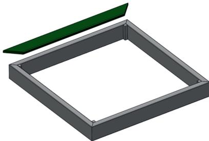
Legen Sie alle Sitzauflagen auf die Seitenteile auf. Verschrauben Sie die Sitzauflagen mit den Seitenteilen von oben mit je 4 Schrauben (6x80 mm) pro Sitzauflage.
